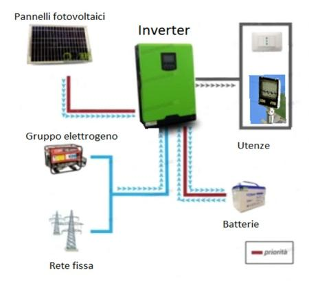
ENERPACK3K è un sistema di produzione fotovoltaica con accumulo, e può essere collegato alla rete elettrica oppure completamente scollegata da essa.
