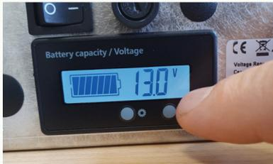
La batteria è in iFeP04, costruita da SPITECNO . Ha una maggiore stabilità termica non è combustibile e non si decompone per corto circuito. La vita è progettata per un 6.000 cicli di ricarica.
